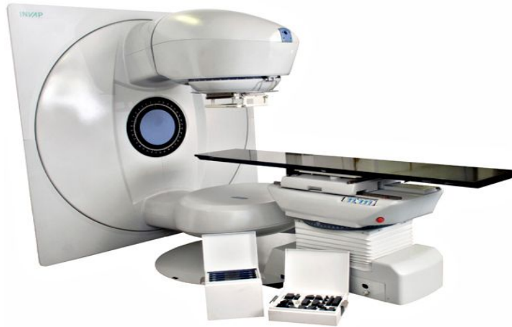
Figura 5. Uso terapéutico de las radiaciones ionizantes. En la foto, un equipo de cobaltoterapia diseñado por INVAP, la unidad Teradi 800, para el tratamiento de tumores sólidos, extraída de [4]
