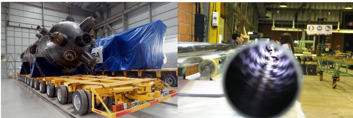
Figura 1. Intercambiador de calor del reactor CAREM listo para su traslado a complejo nuclear en Lima, Provincia de Buenos Aires (izq.). Inspección visual de tubos de presión para el reactor de la Central Nuclear de Embalse (der.)
