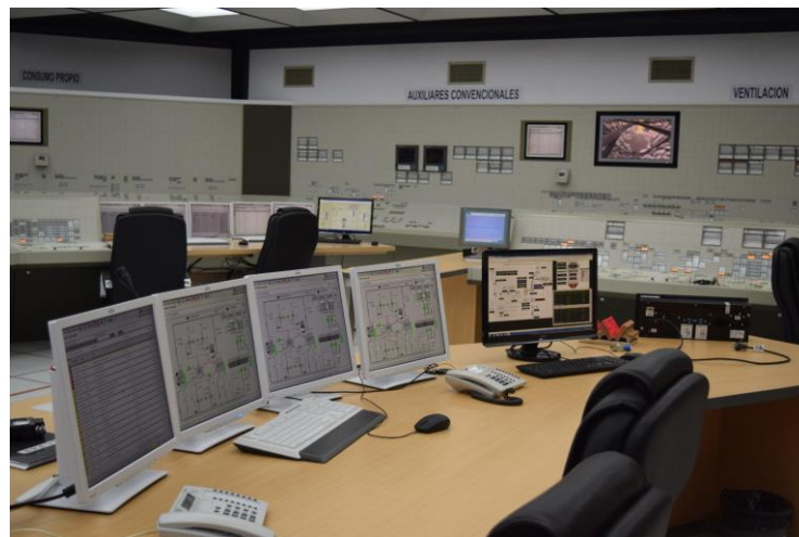
Fig. 2 - SIMULADOR DE ALCANCE TOTAL DE LA CENTRAL NUCLEAR ATUCHA II
